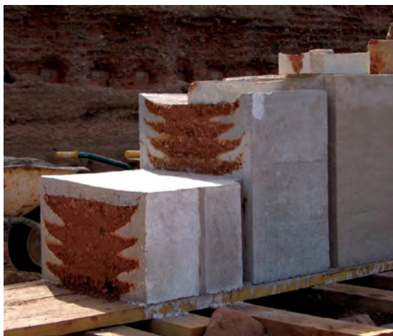
5. Muestras de tapia calicostrada con diversos acabados. Obras del muro 1 de la Huerta Grande del Generalife (2011).
