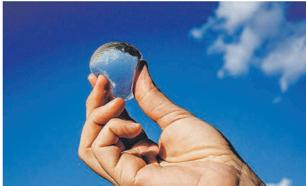
Membrana biodegradable per encapsular aigua i altres líquids, dissenyada per Skipping Rocks Lab. FOTO: K. FAWSETT
