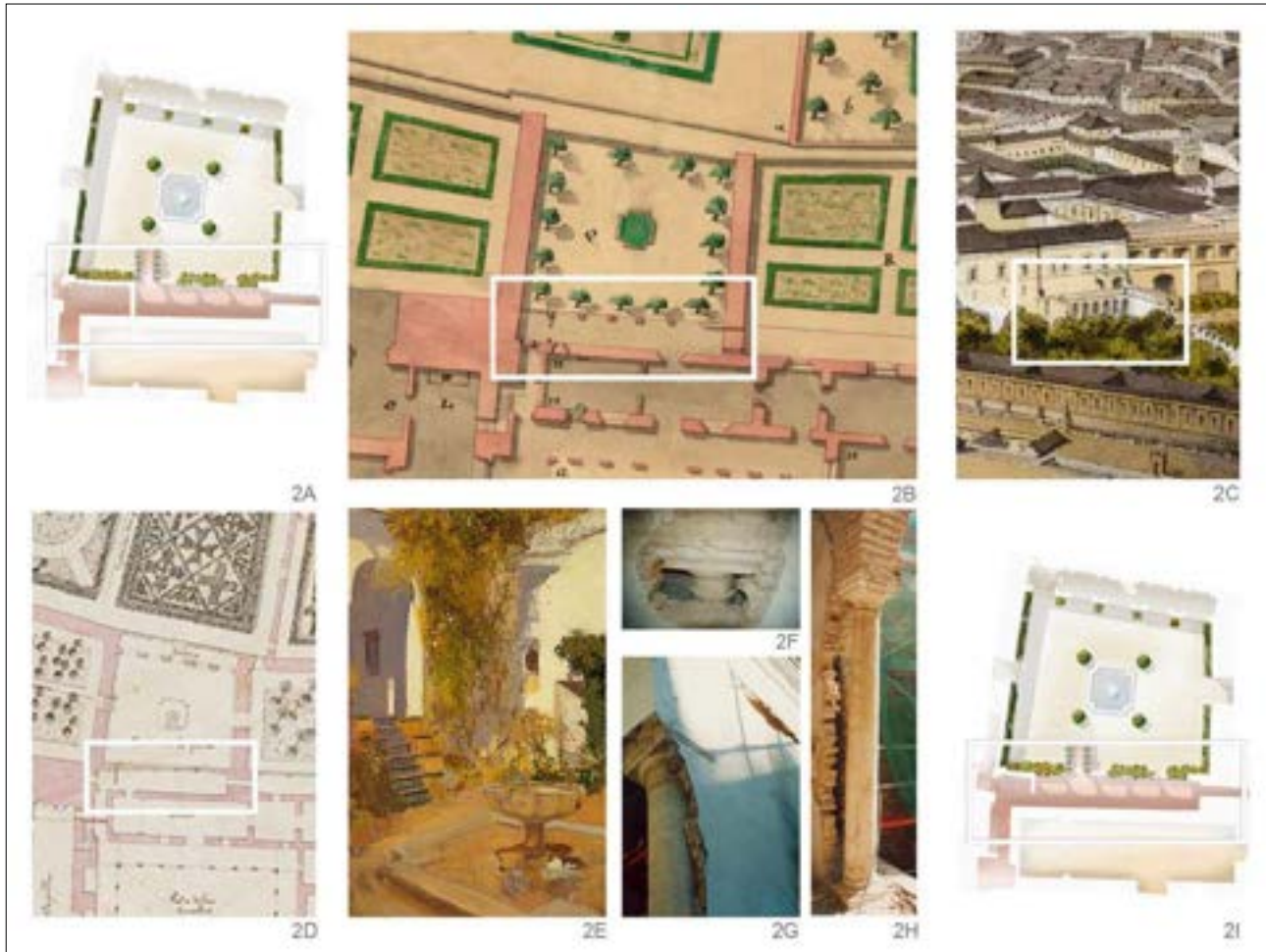
Figura 2. Descubriendo arcos y columnas del siglo XVI en el patio de Troya. 2A) Plano del estado anterior a la intervención. Al iniciar el proyecto de restauración de este patio, durante la investigación documental y gráfica se comprobó que en la galería de cuatro arcos habían existido además otros dos arcos que estaban cegados. 2B) Estos arcos ocultos fueron dibujados en el plano de Sebastián Van der Borcht, año 1759, Archivo de Patrimonio Nacional, donde se representaron seis arcos y cinco columnas, y el trazo superpuesto del cerramiento del arco en el extremo derecho o noreste. 2C) En la litografía de A. Guesdon (1852-1865) de la Biblioteca Nacional de España también había seis arcos y cinco columnas. 2D) Por el contrario, en el plano de Joaquín Fernández, año 1872, Archivo de Patrimonio Nacional, ya solo se representaban cinco arcos y cuatro columnas, con el arco del noreste cegado. 2E) En el óleo de Joaquín Sorolla «Rincón de Grutesco del Alcázar de Sevilla», año 1910, Museo Sorolla de Madrid, aparecen los dos arcos del noreste cegados. 2F, 2G y 2H) Fruto de esta investigación se proyectó recuperar las dos columnas ocultas y el arco que media entre ellas. Siguiendo una técnica arqueológica se hallaron en su sitio las columnas de mármol completas y perfectas, que se dejaron vistas, igual que el arco de ladrillo que soportan. 2I) Plano de la intervención. La restauración se realizó en 2003 y 2004.
